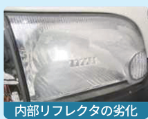
内部リフレクタの劣化
