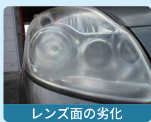
レンズ面の劣化
